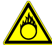
Warnung vor brandfördernden Stoffen
