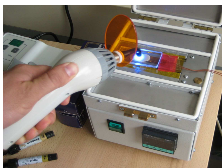
Alterungsmessung an einem Dentalkomposit über dielektrische Analyse DEA
